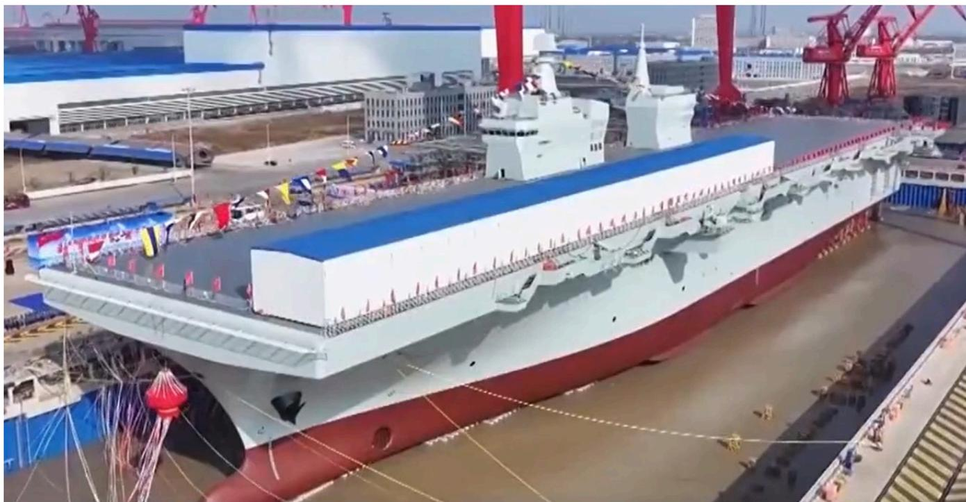
2024年12月27日，中共的076型两栖攻击舰下水，仍模仿美军两栖攻击舰，但在紧靠甲板一侧加装了飞机弹射器。（视频截图）
