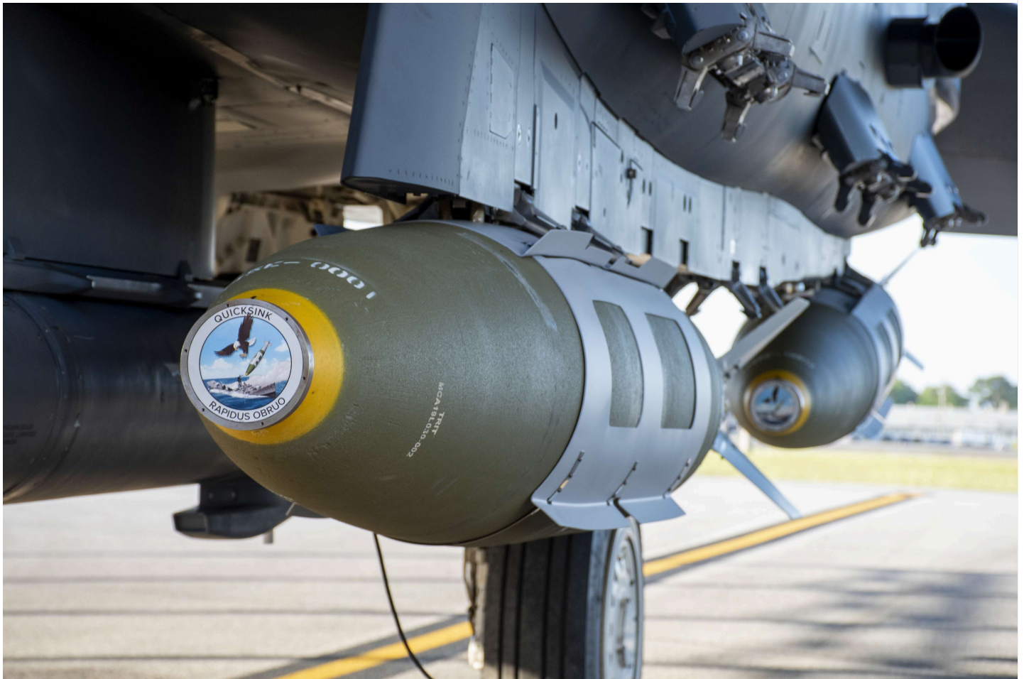
美军战机可搭载的2,000磅GBU-31联合直接攻击弹药（JDAM），被用作快速击沉（QUICKSINK）的空中武器。（美国空军）
