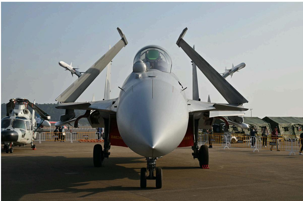
2024年11月12日，中共的改进型航母舰载机歼-15T在珠海航空展上亮相。两侧机翼下仍只挂载4枚空对空导弹。
